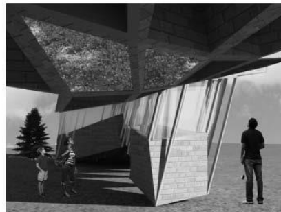
Imagen 95. Generación de una volumetría compleja a partir de una malla tridimensional que surge de un campo alterado por puntos atractores. Es decir, existe una variación posicional de los puntos de la malla que surge como reacción a la proximidad respecto de un punto específico.
