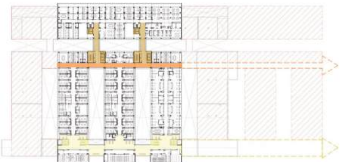
Fig. 4.1.3 Planta Alta con espacio para crecer sobre la planta baja, y dos circulaciones verticales técnicas y dos públicas que permiten separar flujos para utilizar parte del edificio para una patología infecciosa en un caso abrupto de pandemia.
