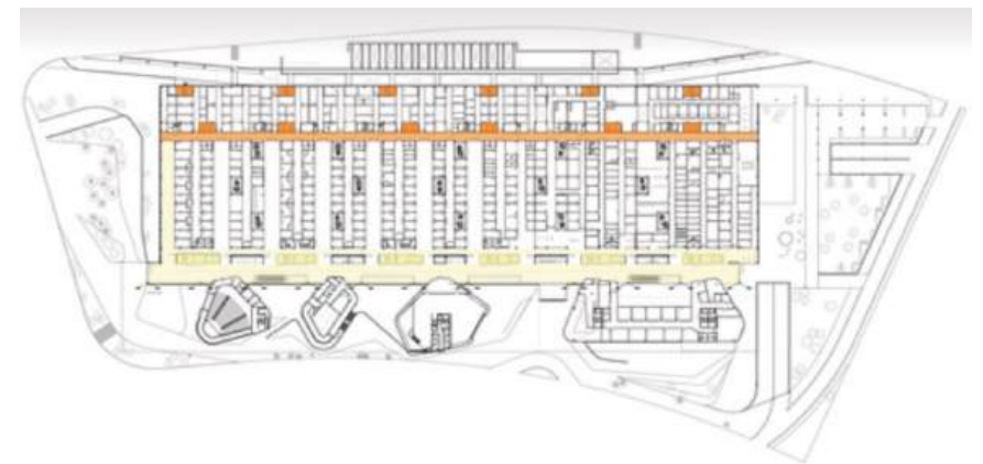
Fig. 4.4.3 y 4.4.4 Plantas de 1° Subsuelo y Baja, donde se pueden ver las circulaciones troncales horizontales que abastecen todos los servicios asistenciales, las plantas continuas que permiten flexibilidad en el uso, y la variedad de circulaciones verticales ubicadas en forma equilibrada que permite diferenciar y aislar circuitos en caso de una emergencia epidemiológica.
