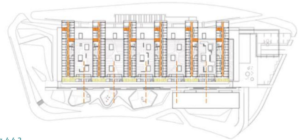
Fig. 4.4.2 Plantas de internación, donde se pueden ver los bloques independientes abastecidos cada uno por circulaciones verticales que admite diferenciar y aislar sectores en caso de una emergencia epidemiológica.
