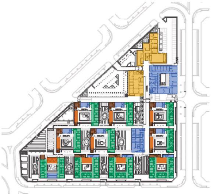
Fig. 3.10.2 Planta de Conjunto donde se pueden ver las 10 unidades de vida que contienen usos diferentes y ocupan gran parte de la superficie del edificio, y los sectores específicos de diagnóstico y tratamiento, y docencia e investigación.
