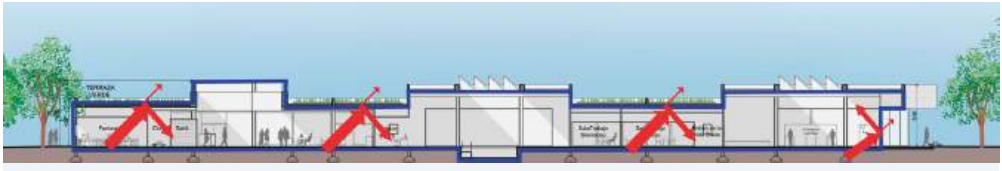
Fig. 8.2.4 Envoltura con gran aislamiento térmico que reduce significativamente el consumo energético para climatización.
